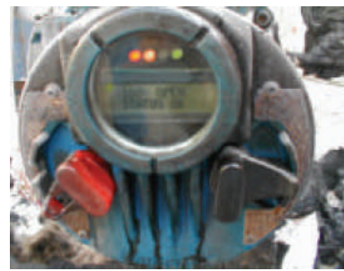
測試後檢查內部設備未毀損
